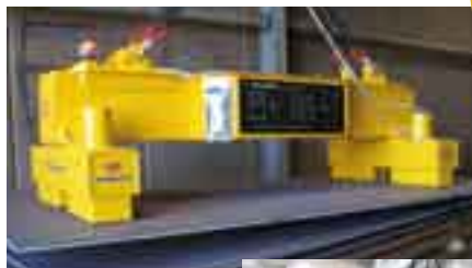
BF /TG voor lasten met een wanddikte vanaf 1,5 mm
