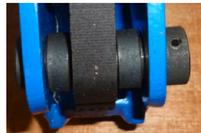
Geen uitstekende borgpennen, tandsegment opgesloten door bussen
